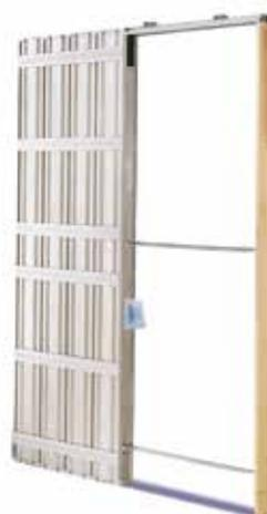
Permet de dissimuler une porte coulissante. Pour cloison en plaque de plâtre épaisseur 100 mm (54 mm de vide interne). Pour porte de 40 mm épaisseur maxi. Structure en acier zingué. Panneaux latéraux pleins.
