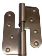
Paumelle hélicoïdale à entailler en inox brossé 304, à lames. Bouts ronds. Élévation de 12 mm.
