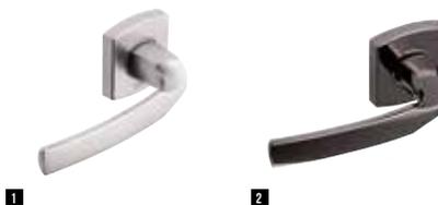
Saillie de la béquille : 60 mm. Serrure entraxe de 70 mm. Sous-rosace en polyamide chargé en fibre de verre. Piliers pour fixation traversante entraxe 38mm et vis invisibles. Ressort de rappel intégré. Livrée avec carré de 7 mm et vis de fixation M4. Rosaces modèle 6425, à commander séparément.
