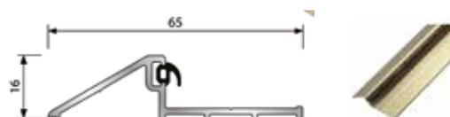
Seuil en aluminium pour l'étanchéité de la partie basse des portes d'entrée. Utilisable en rénovation ou en neuf avec contreprofilage du pied dormant. **Joint GSL monté sur le seuil.**
