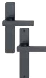
Ensemble en aluminium anodisé sur plaques fondues. Serrure entraxe 70 mm. Carré à montage rapide. Livré avec carré de 7 mm et vis de fixation M4.
