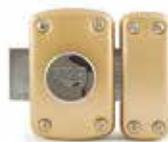
Coffre et gâche en acier embouti, ép. 20/10ème. Cylindre laiton Ø 23 mm, 6 goupilles laiton. Ressort en acier inoxydable. Bouton en zamack. Pêne en acier chromé de 110 mm et 2 tours. Modèle varié : livré avec 5 clés à points réversibles. Modèle sur même numéro : livré avec 3 clés.
