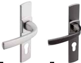
Ensemble en zamack monobloc : béquille et plaque solidarisées. Serrure entraxe de 70 mm. Piliers taraudés intégrés et vis invisibles côté extérieur. Livré avec carré de 7 mm et vis de fixation M4.
