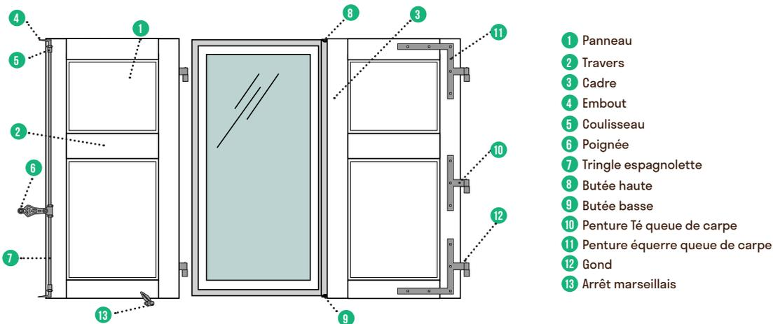
Persienne occultante de 33 mm avec encadrement composé de 2 montants et 2 traverses. Panneaux assemblés sur les montants par rainures et languettes. Traverse intermédiaire ajoutée à partir de 1690 mm de haut et 2 traverses intermédiaires à partir de 2500 mm.
